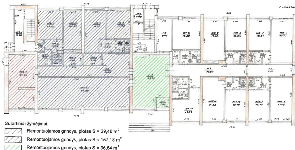
3 pav. Reikalingų remontuoti pirmo aukšto grindų zonos bei jų plotai
