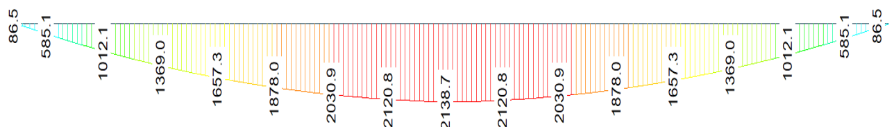
Paveikslas 4. Skaičiuotinių lenkimo momentų diagrama ( M_{Ed,max}=2138,7 kNm)
